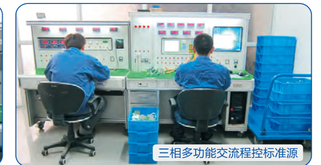
校准单相及三相电力仪表的多功能校验台
