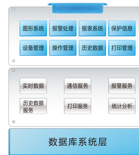
能耗管理系统体系结构图
